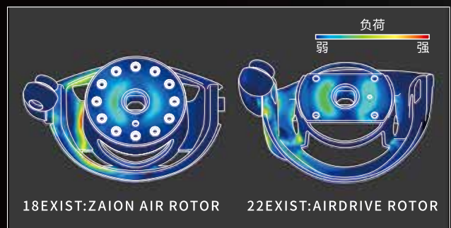
转盘摇臂的强度模拟试验显示，它比18EXIST更轻，但硬度却毫不逊色。此外如上图所示，超轻驱动转盘在受力集中的地方进行了加固，并将多余的部分剔除以分散负荷，从而兼顾了轻量 and 硬度。转动体的理想设计，仿佛从一个球体中切割出来一样。产生理想的转动平衡。
