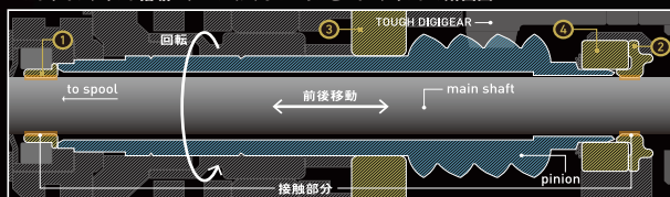
エアドライブシャフト搭載モデルにおけるピニオンとメインシャフトの断面図
