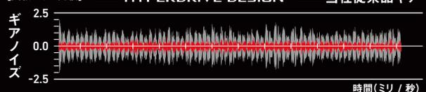
こちらは巻き上げ時のギアノイズ(ハンドル回転時のザラつきなど)の測定結果。振れ幅が小さいほどノイズが少ないことを意味する。従来ギアとの比較で、HYPERDRIVE DIGIGEARのノイズレベルは50%以下へと大幅に減少(当社比)。滑らかで静かな巻き心地を実現する。
